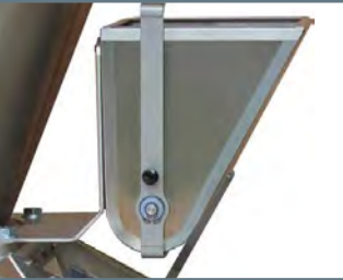
Flour duster with regulating device for released flour Sfarinatore con regolazione della quantità di farina rilasciata
